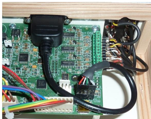
**Option 2 :** utiliser la carte DS\_Connect. Utiliser un câble USB blindé pré-monté de ce type par exemple et le couper en deux pour souder les fils sur DS\_Connect. Sur la carte DS\_Connect, le châssis est relié aux deux pattes de fixation.
